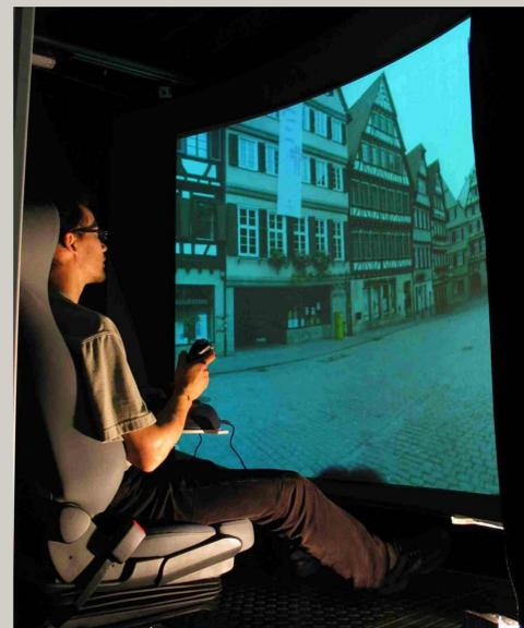
Abb. 1: Versuchsperson vor der Projektionsleinwand, auf der die Szene des Tübinger Marktplatzes projiziert ist. Das simulierte FOV war dem physikalischen FOV angepasst und betrug 54°x40.5°.
